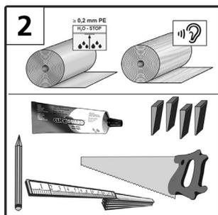
**Подготовка:** Выдержите, пожалуйста, пакеты в течение 48 часов перед укладкой при тех же климатических условиях, что и при укладке [1]. Важной предпосылкой для монтажа и длительного поддержания ламинатного пола в сохранности является климат в помещении с температурой прим. 20°C и относительной влажностью воздуха 50 - 70%.
