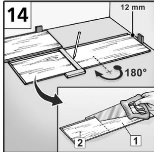
Укладку следует начинать в левом углу помещения. Первую панель укладывают гребнем к стене и зазор от стены фиксируют распорными клиньями. Следует обязательно соблюдать отступ шириной 12 – 15 мм (компенсационный зазор) от стены, отопительных труб, колонн, дверных порогов и т.д. [12].
