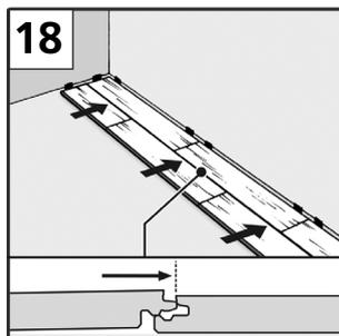
Начните второй ряд с укладки половины панели (длиной  $\leq 95$  см) или упомянутого остатка (длиной  $\geq 30$  см) [15-17]. При этом вложите кусок панели с продольной стороны в профиль паза 1-го ряда и закрепите/поверните под углом. [17, 18]. Смещение поперечного шва от ряда к ряду должно составлять соответственно мин. 30 см.
